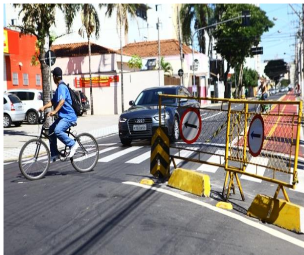
Figura 6. Solução junto à Área Central induz o ciclista a se misturar com o tráfego motorizado
